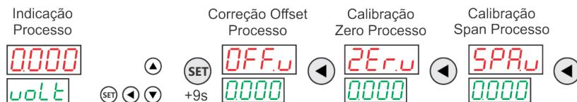
Correção Offset Processo      Correção Zero Processo      Calibração Span Processo
