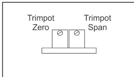
Aplique a pressão corresponde ao zero da faixa e faça o ajuste necessário no respectivo trimpot de zero ate obter o valor desejado no medidor.
